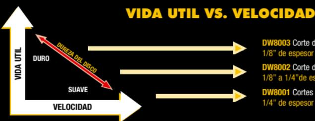
DW8003 Corte de perfiles de acero y metales ligeros hasta 1/8" de espesor
