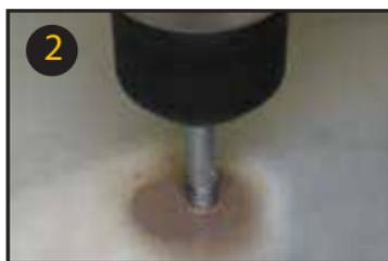
1. Mantenga arriba la extremidad sinterizada de la broca. Asegúrese de humedecer constantemente la superficie con agua. Mientras la perforación ocurre la línea que guía el taladro y mantiene el curso evitando cualquier desviación. La fácil remoción de la broca asegura que las perforaciones pueden hacerse rápidamente.
